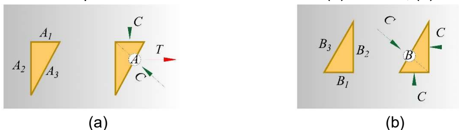
Figura 2.10 – Tipos de nó no modelo biela-tirante: (a) Nó CCT; (b) Nó CCC
